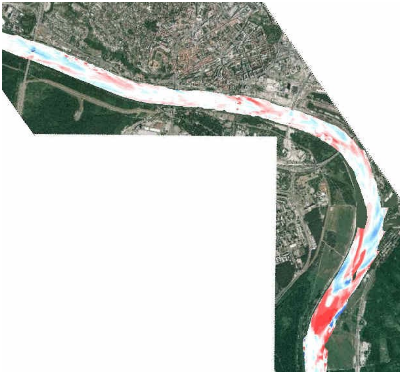
Obr. 3 Zmeny morfológie koryta Dunaja v úseku pod Bratislavou v období r. 2007-2009 (SVP š. p., OZ Bratislava) - Červenou sú vyznačené lokality s prírastkom sedimentov až do 4 m.
